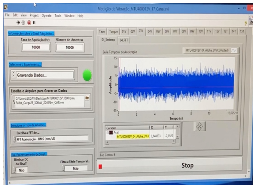
Figura 13 - Interface gráfica do software LabVIEW™ utilizada para aquisição de sinais de vibração do motor MTU 12V4000C11
