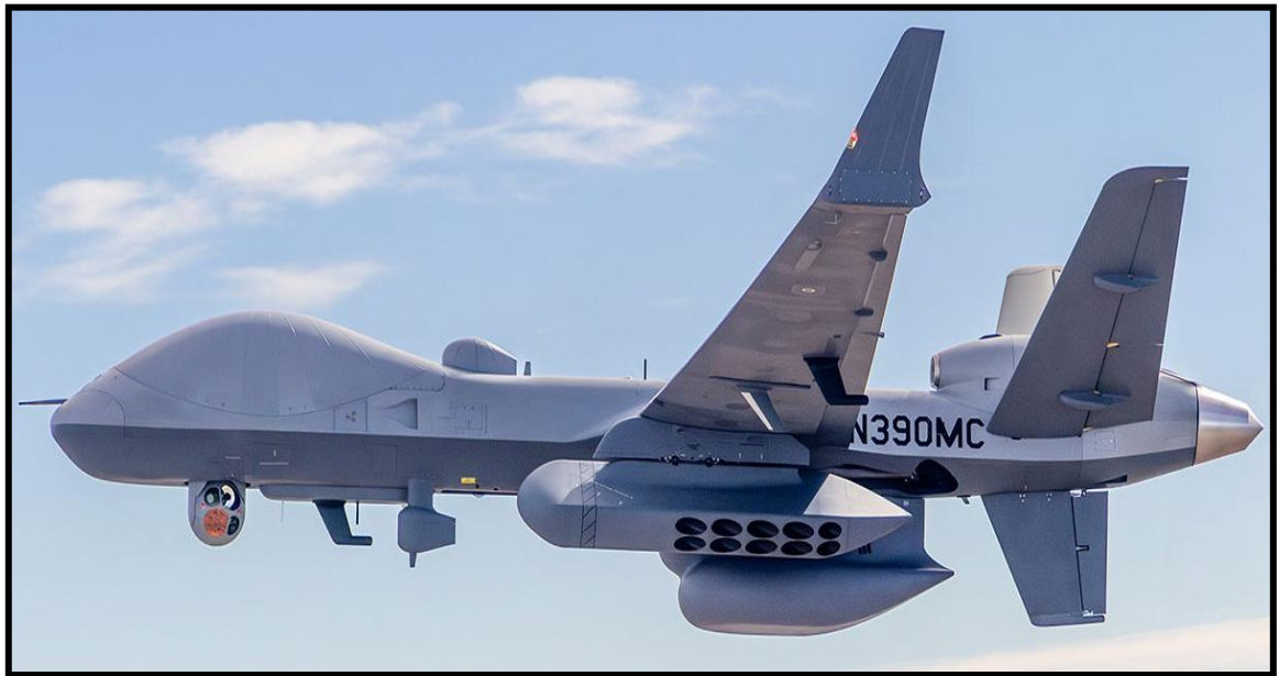
Figura 3 - MQ-9B com lançador de sonobóia
