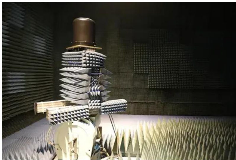
Figura 3 - Antena do MAGE Defensor MK3, desenvolvido pelo IPqM, em câmara anecóica.
