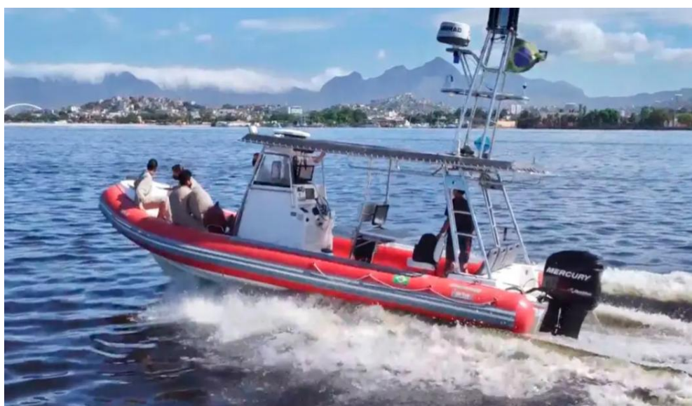
Figura 9 – Lancha URCA-III adaptada como USV.
