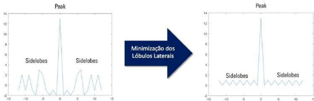
Figura 2 - Efeito da minimização dos lóbulos laterais (sidelobes).
