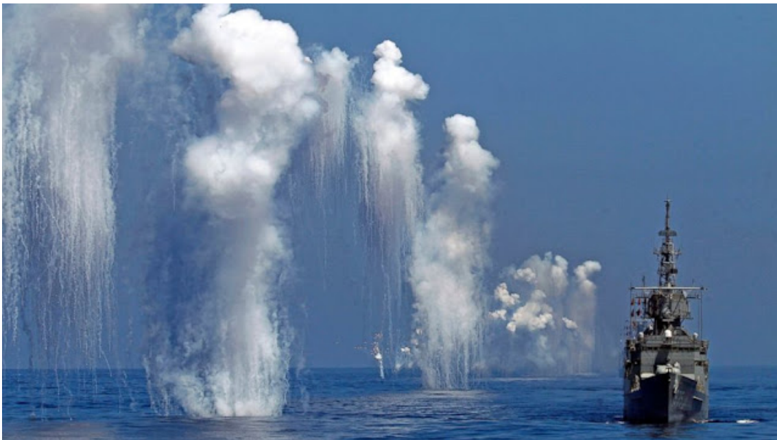
Figura 4.14: Dispersão de chaff (nuvem de fibras de carbono) para proteção naval.
