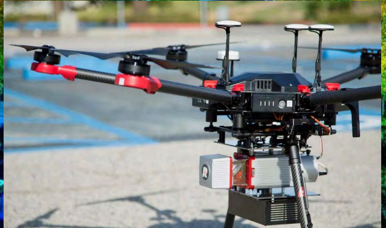
DJI Matrice 600 integrado con sensor LIDAR de la empresa RIEGL
