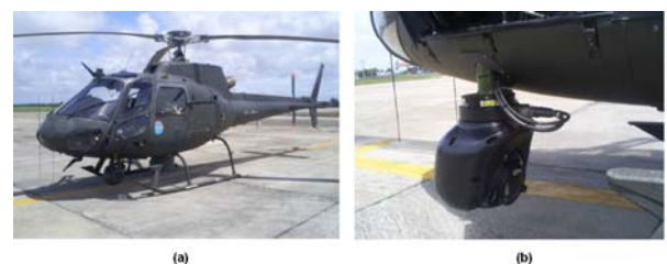
Fig. 5. Uso de tecnologia FLIR no Brasil: a) Helicóptero HÁ-1 Fennec, do EB, equipado com câmera de imagens térmicas FLIR 2000 da empresa FLIR Systems e b) Detalhe da câmera térmica instalada no helicóptero.[6]
