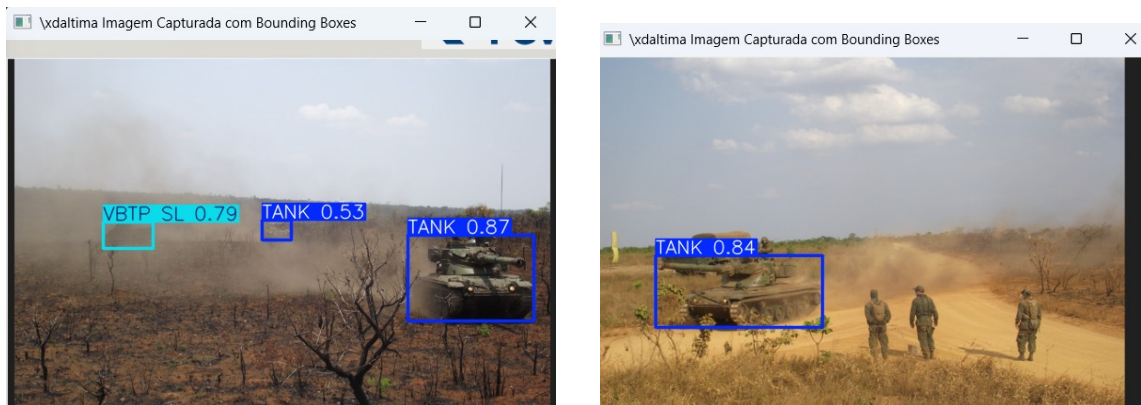
Figura 12: Exemplos de detecção em tempo real pelo software: (esquerda) múltiplos alvos em ambiente diurno; (direita) detecção em vídeo com movimento de câmera.
