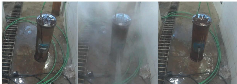
Figura 3.3 – Teste de ruptura.
