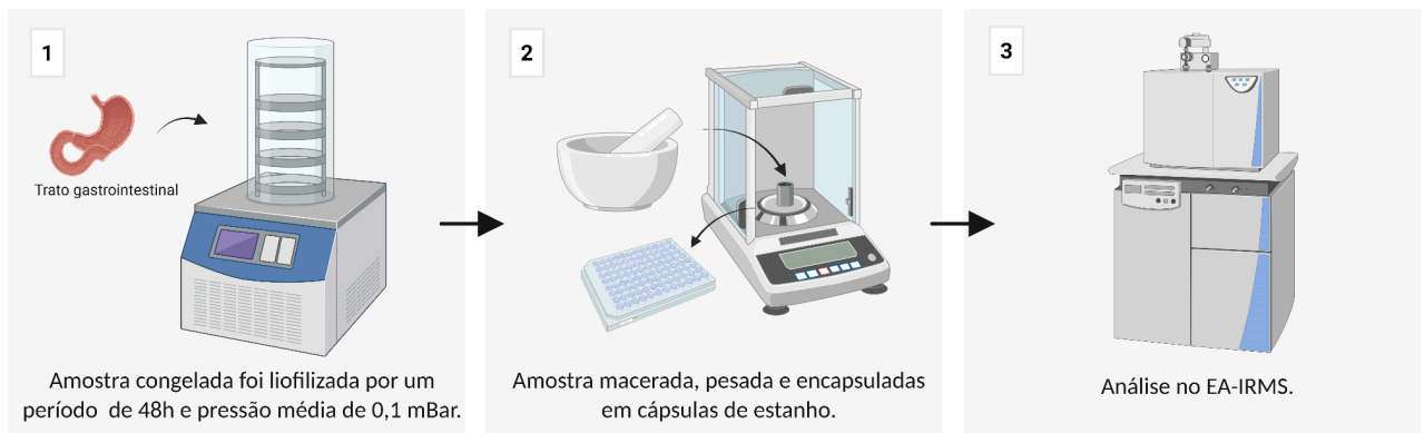
Figura 11. Esquema do preparo e da análise do tecido do trato gastrointestinal para análise de isótopos estáveis de carbono (C) e nitrogênio (N). Fonte: A autora, (2026).
