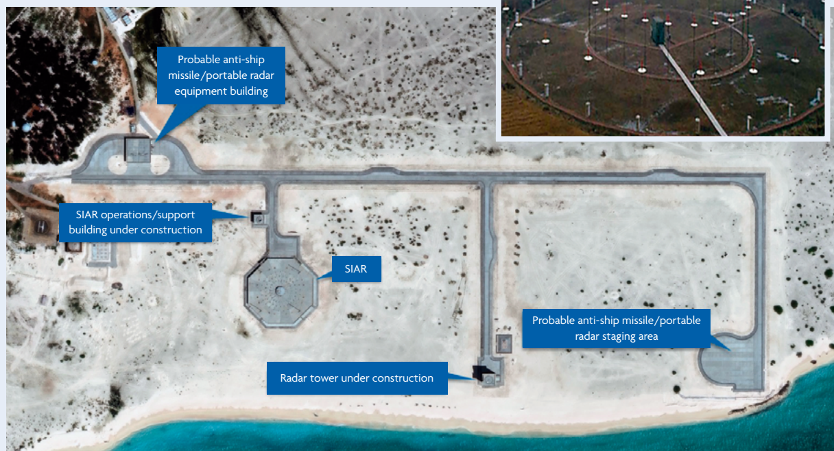
Synthetic Impulse Aperture Radar (SIAR), testado na Ilha Triton, integrando vigilância no Mar do Sul da China. Fontes: Stroski (2019), Asian Military Review (2018), Aliabad et al. (2021) e Clark (2024).
