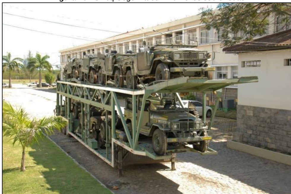
Figura 10 - SRbq Cegonha com Vtr Leves sobre rodas
