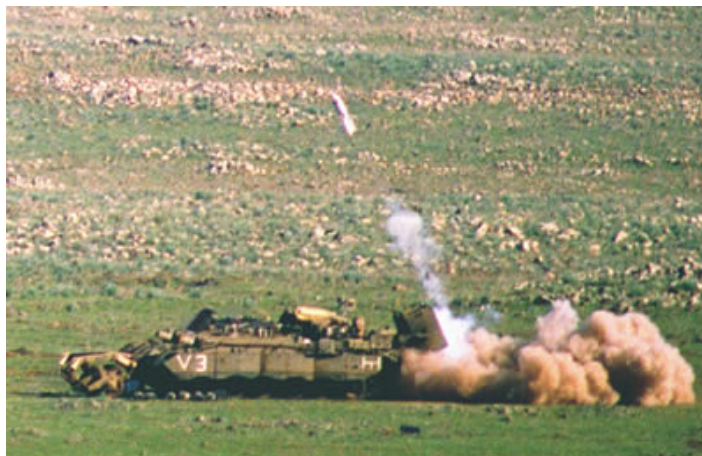
Figura 9: Carpet em operação, acoplado a um Puma Fonte: Site Defense Update
