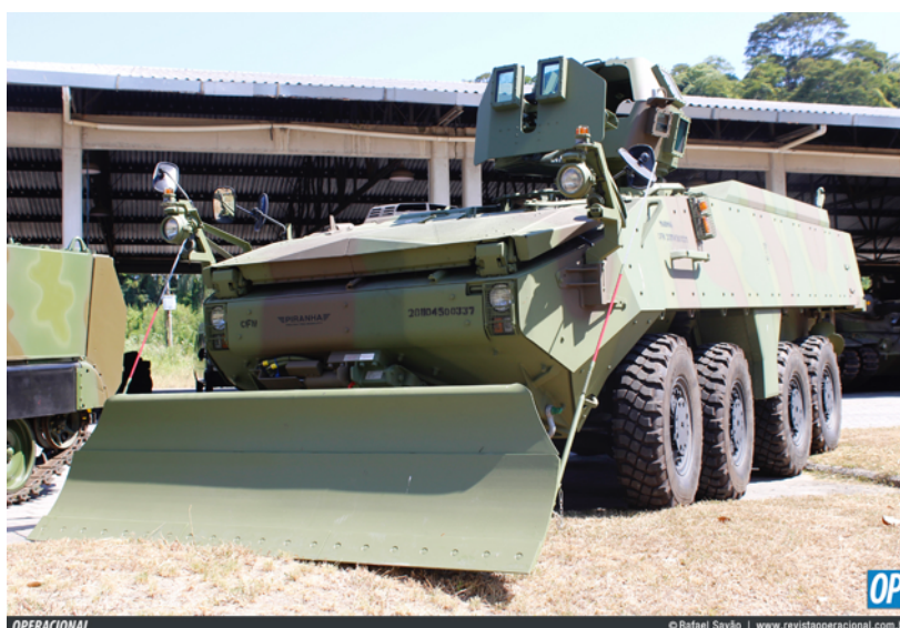
Figura 11: Viatura Blindada Piranha IIIC equipada com implemento de lâmina Fonte: Site Plano Brasil
