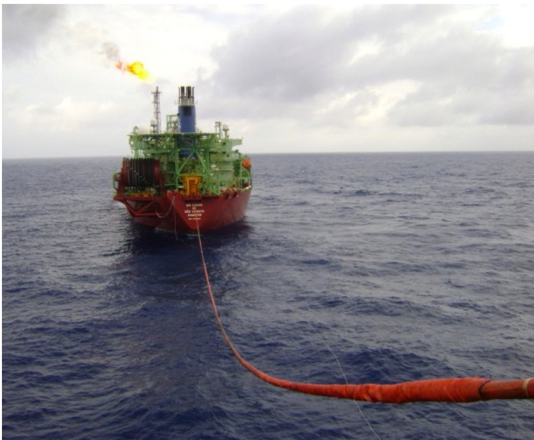
Figura 10: Cabo hawser do FPSO Cidade de São Vicente.
