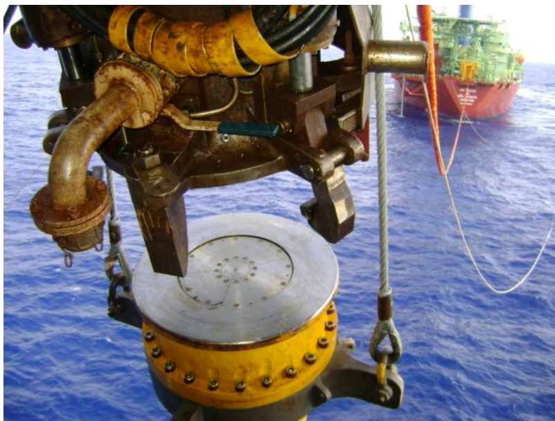
Figura 11: North sea valve do FPSO Cidade de São Vicente na bacia de Santos.
