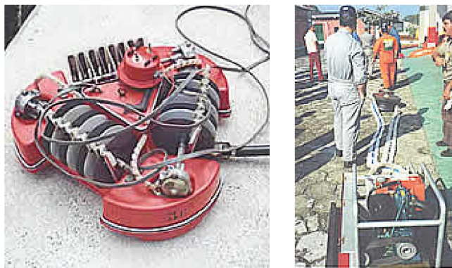
Figura 13: Skimmer de disco e Skimmer de fita
