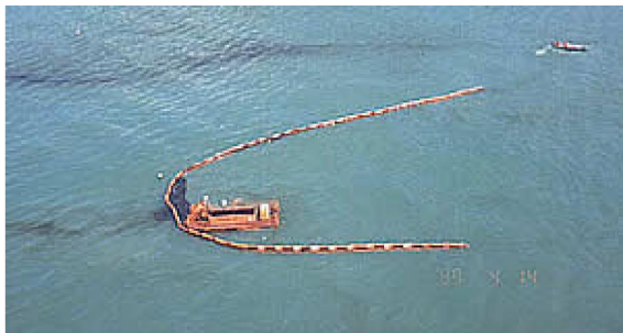
Figura 12: Contenção e remoção com barcaça recolhedora
