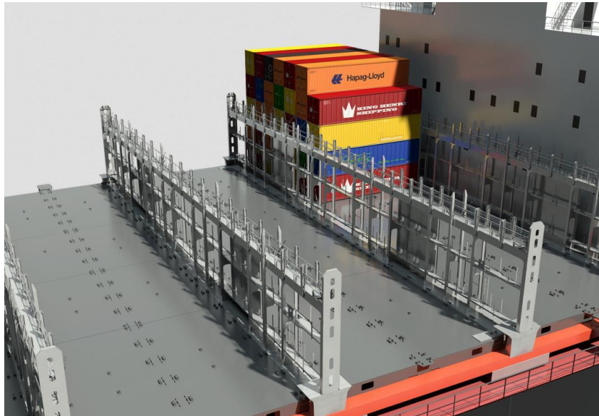
Representação da utilização de lashing bridges em navios full contêineres.
