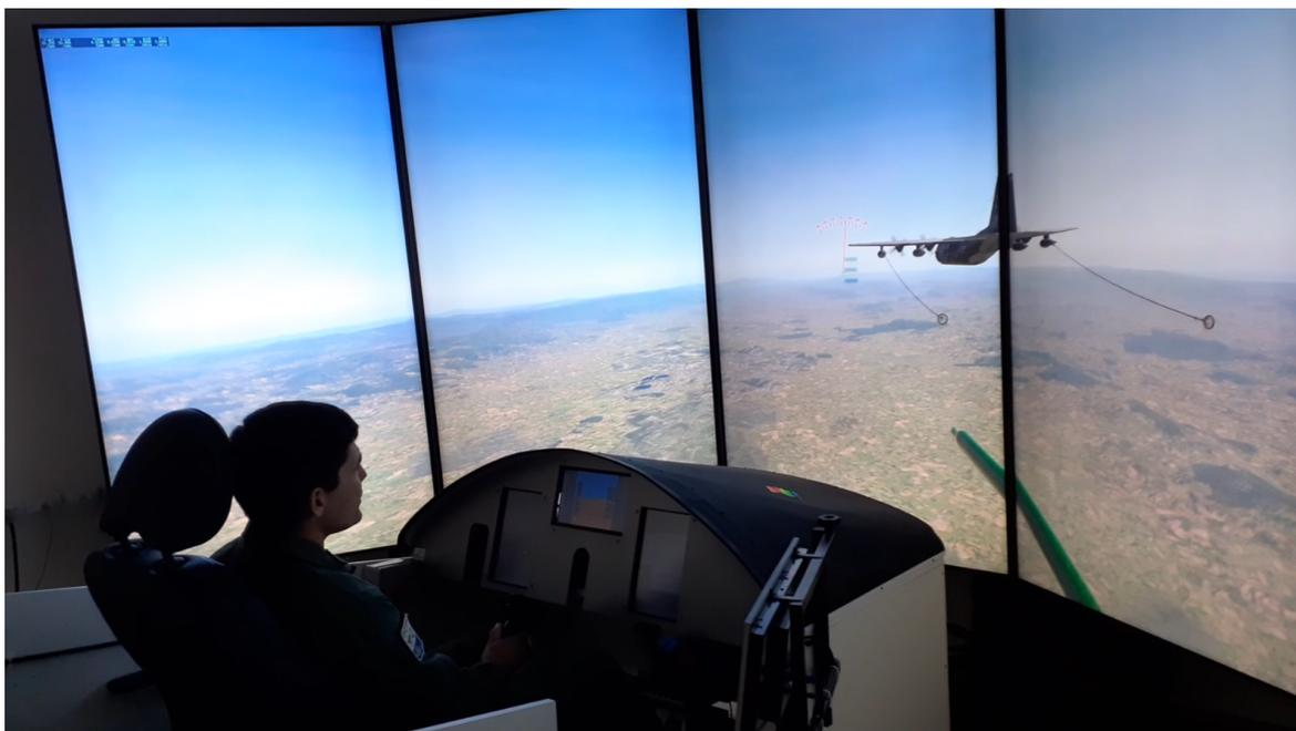
FIGURA 3.2 – Ambiente de simulação usado para o teste com os pilotos. A tarefa realizada a transição para da posição de observação para a posição de pré-contato.
