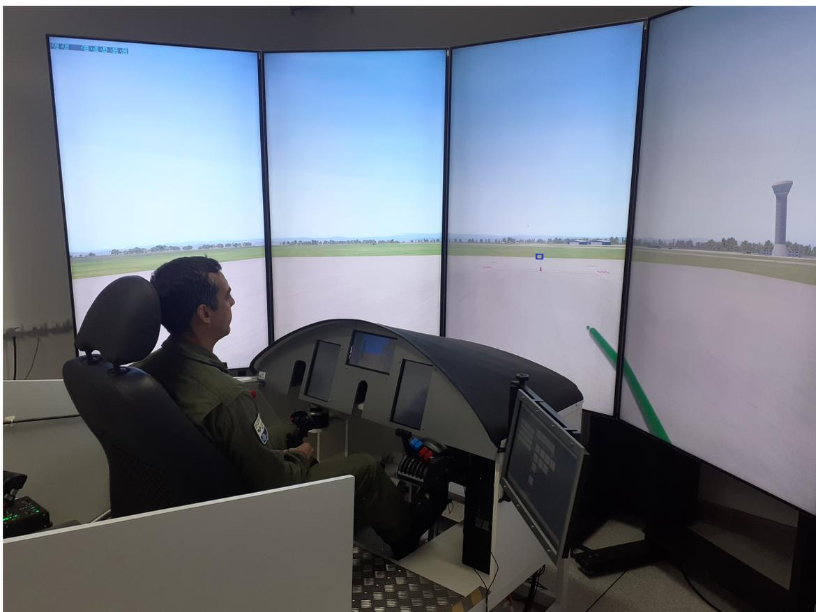
FIGURA 3.1 – Ambiente de simulação usado para o teste com os pilotos. A tarefa realizada é a manutenção de voo pairado com o alvo dentro do quadrado mostrada na figura.
