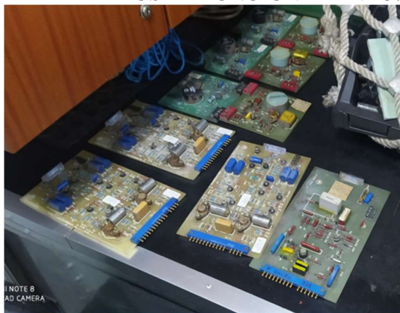
FIGURA 29. CARTÕES DA UTR EM BANCADA PARA ANÁLISE DE SEUS PARÂMETROS DE FUNCIONAMENTO.
