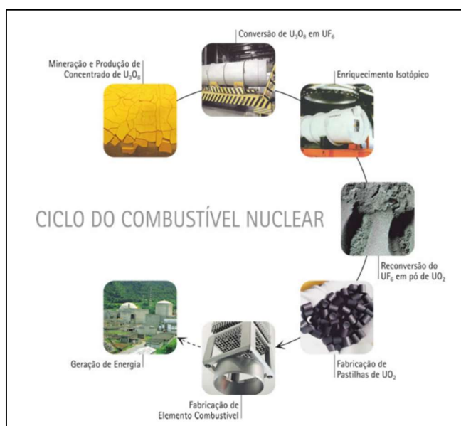
Figura 3 - Ciclo do Combustível Nuclear, ilustrando as diversas etapas que o urânio percorre, desde sua extração inicial até a geração de energia em uma usina nuclear.
