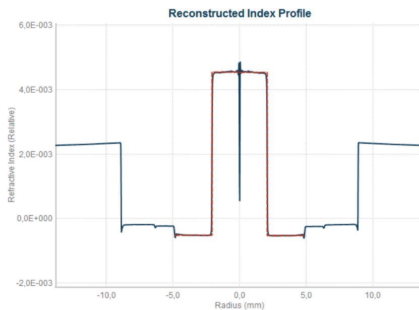
Figura 34 – Perfil de índice de refração para análise de preforma teste no analisador de preforma Photon Kinetics modelo 2650 a uma distância axial de 350 mm da base da preforma.
