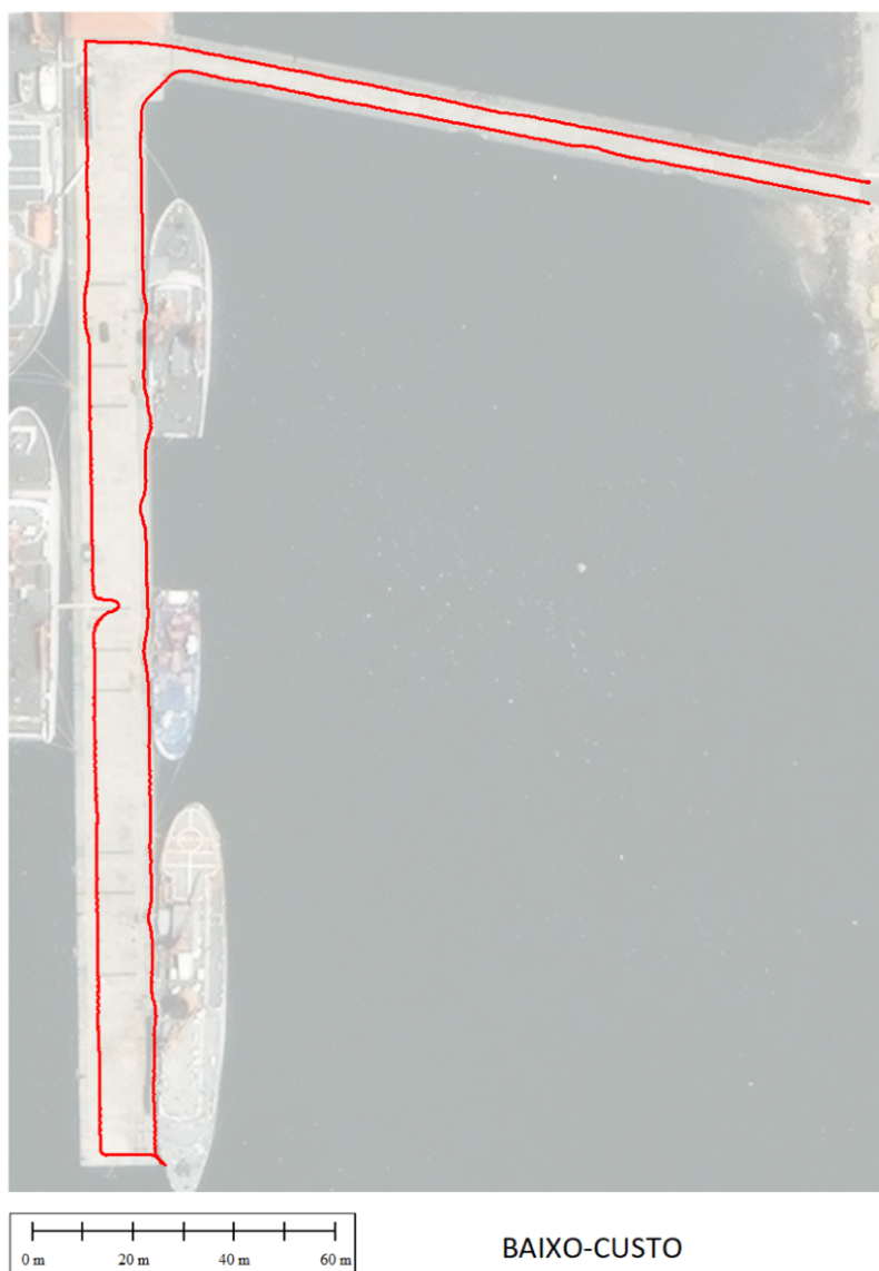
Figura 9 - Rastreo cinemático com receptor de baixo custo
