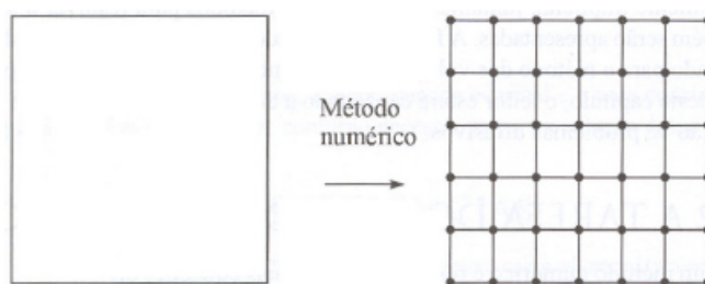
Figura 15: Processo de discretização espacial
